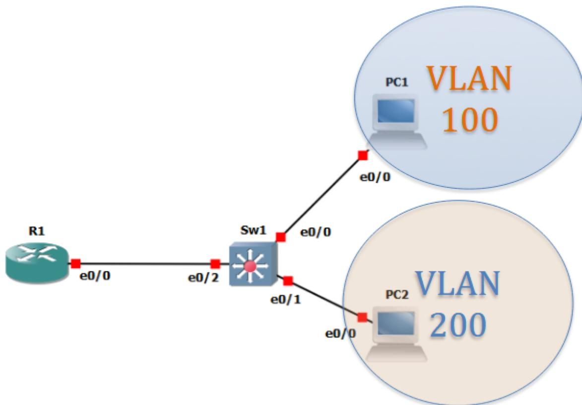
Tout d'abord, l'interface qui va relier le routeur au switch devra être configuré en mode Trunk.
